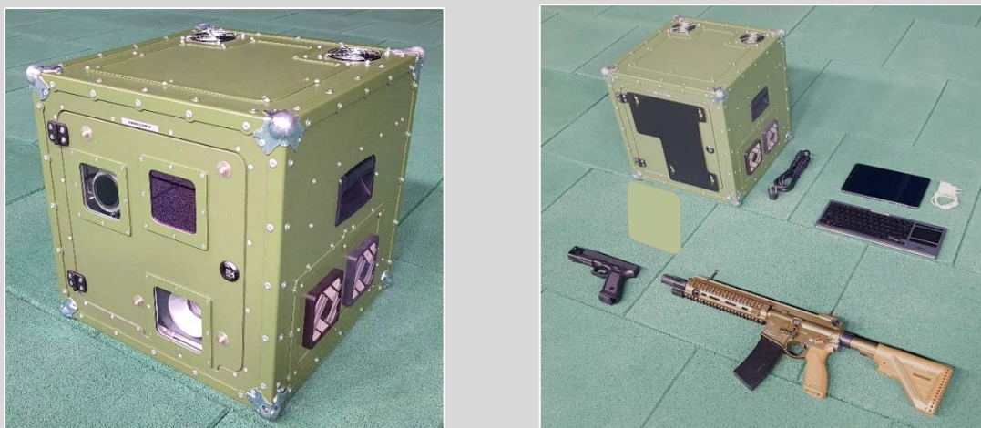
Rys. 2 Zasadnicze zespoły systemu: Po lewej stronie – Moduł Projektji ze zdjętą osłoną transportową. Po prawej stronie (drugi plan od prawej) Moduł Projektji z kablem zasilającym, tablet z zasilaczem, klawiatura bezprzewodowa z gładzikiem; (pierwszy plan od prawej) broń treningowa. Widok może różnić się w zależności od docelowej konfiguracji urządzenia w ramach specyfikacji indywidualnej dostawy.
